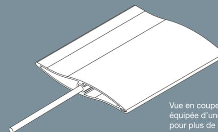
Vue en coupe d'une lame équipée d'une tige fileté pour plus de solidité
